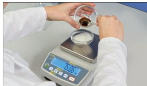
Con ayuda de la **función de formulación** es posible pesar los componentes diversos de una mezcla. Como medida de control se puede indicar el peso total de todos los componentes
