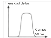
El difusor HEINE conectable produce una luz suave para reconocimientos más fáciles y sin deslumbramiento con poca pérdida de intensidad de luz. El difusor se puede combinar con todos los filtros.
