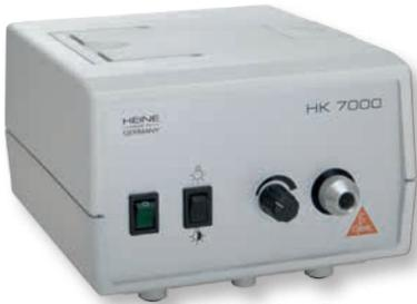
El proyector para fibra óptica HK 7000 tiene una lámpara halógena especial de alta potencia de 150W de larga duración. Para exploraciones en las que se desee más luz, se puede aumentar la intensidad de luz temporalmente hasta un 40 % con un interruptor de aumento. Puede usarse para todos los instrumentos HEINE con iluminación de fibra óptica (F.O.) Dimensiones: Ancho: 177 mm, Alto: 125 mm, Profundidad: 217 mm. Peso: 3690g.
