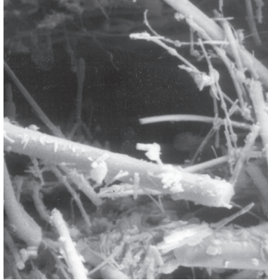
Imagen magnificada de la superficie del filtro mostrando los depósitos de contaminantes
