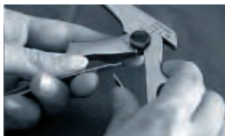
Remove retaining button Retirar botón negro de ensamble Schwarzen Halteknopf entfernen
