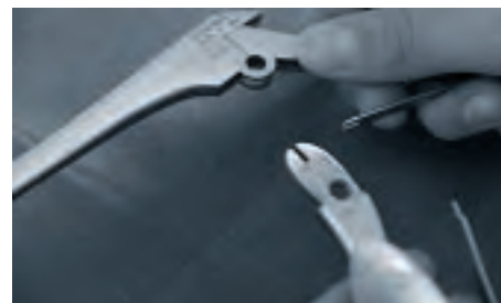
Insert handle Insertar mango Handgriff einrasten
