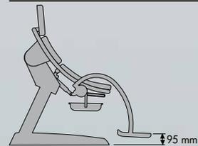
La distancia entre los porta-pies y el suelo es de 200 mm, si la placa de asiento está en nivel horizontal, y de 95 mm si la placa de asiento está inclinada hacia abajo.
