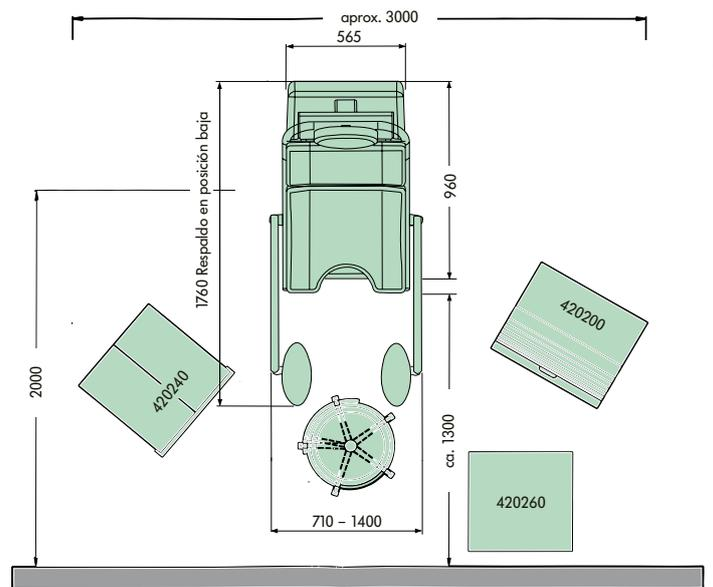
En el caso de instalación fija del sillón, el cable tiene que quedar debajo de la placa base. (960 x 565 mm)
