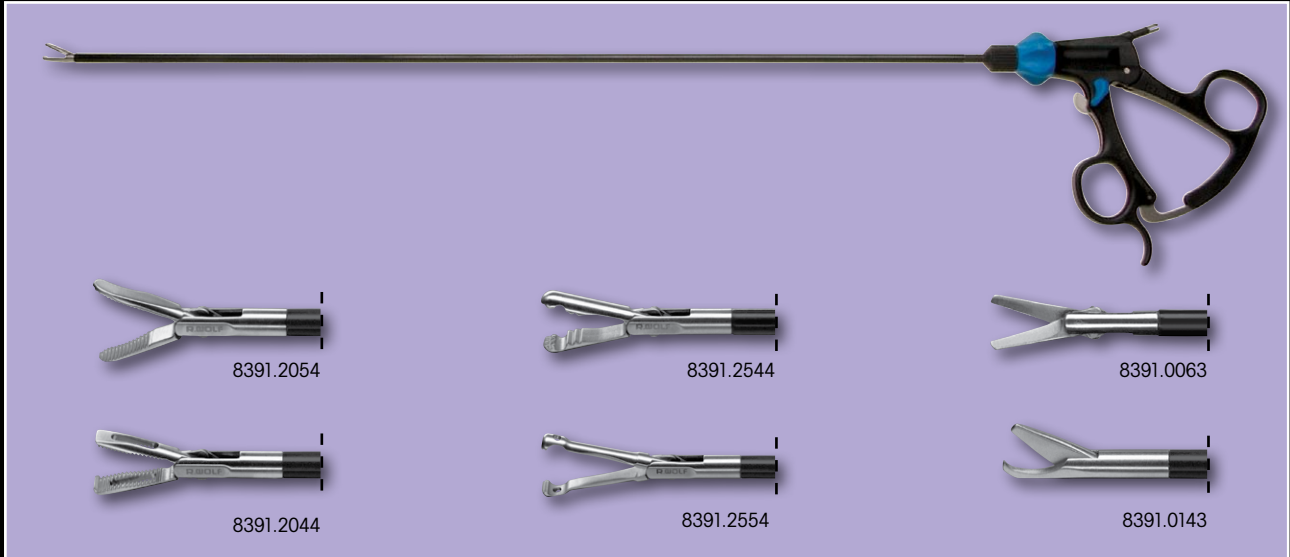
«Maryland Dissector», pinza de agarre y disección, curvada a la izquierda, ambas mandíbulas móviles, ø 3,5 mm, LU 310 mm ..... 8391.2054
